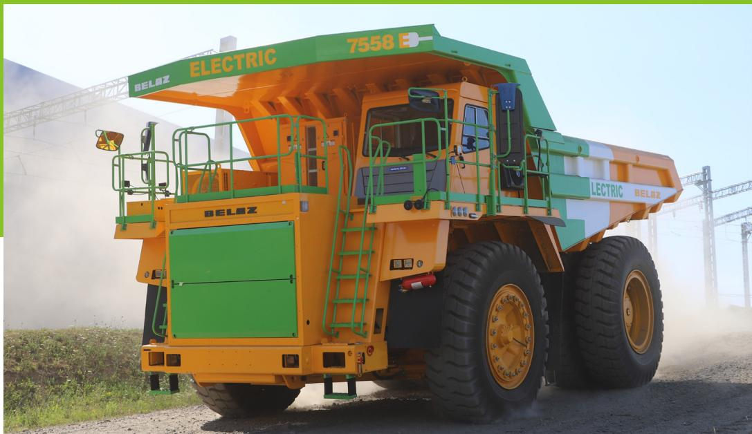
БелАЗ выпустил модель 7558Е. Грузоподъемность новинки – 90 тонн. Под капотом расположилось более 8 тонн литий-ионных аккумуляторов; самосвал оснащается сразу двумя энергоблоками с общей пиковой мощностью 675 кВтч. Установка позволяет разгоняться до 65 км/ч, что даже выше, чем у дизельных родственников. Время работы на одном заряде составляет от 2 до 8 часов, а полной зарядки – 20 минут.
